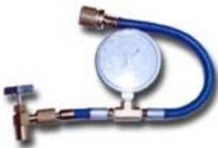
\* Aparato de aplicación de la recarga de aire acondicionado R- 134a, cuenta con un manómetro especial para medir la presión del sistema de enfriamiento, lo que permite identificar la cantidad necesaria de producto, para recargar sus sistemas. Así mismo cuenta con una aguja que sella perfectamente el bote de aerosol y con esto se previene la pérdida de producto.
